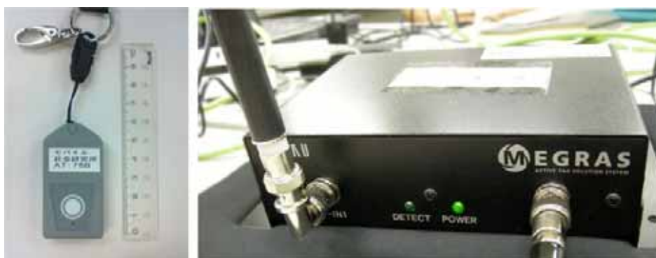
図 RFIDシステム(左:RFIDタグ、右:受信機)
